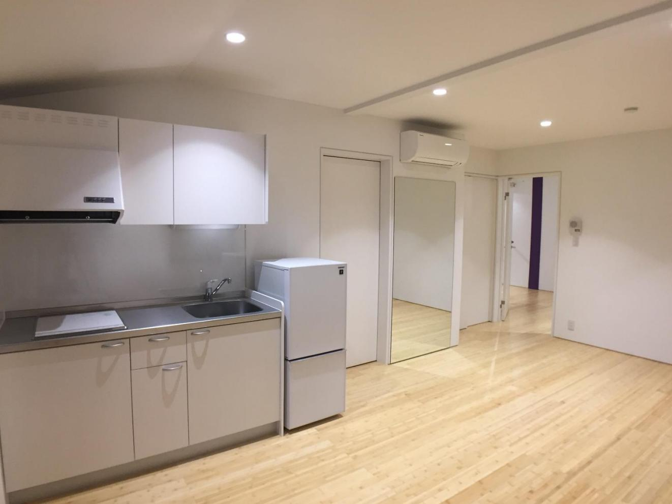
1階 ROOM4 ワンルーム寮 約30㎡：キッチン並びに姿見背面に、風呂・洗面・洗濯・ワードローブ・トイレを直線配置している。寝・食・居間スペースの最大化シンプル化を図った。住戸間仕切り壁が1階の東西方向構造壁となる。
