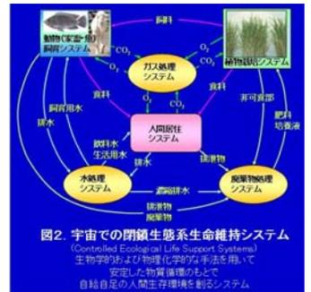
図2. 宇宙での閉鎖生態系生命維持システム (Controlled Ecological Life Support System) 生物学および物理・化学的手法を用いて、安定した物質循環のもとで、自給自足の人間生存環境を創るシステム
